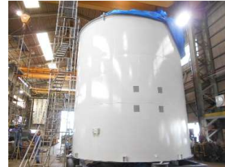
補給水タンク
